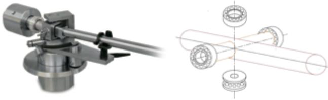
アームパイプは音質にとても影響が出るところです。アームの内側にはまずカーボン繊維で、またその内面はグレードの高いポリの繊維で防振しています。そして電気信号を送る線は低抵抗の銀線を使用し、絹糸で巻きその周りをこのポリの繊維でダブルに防振しています。
