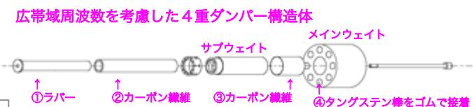
ヘッドシェルは削り出しの一體構造としたことで、振動ロスを大幅に減少させました。また、不要な贅肉は極力そぎ落とし、ステンレスでありながらアルミ製と同等の軽量化を図り、しっかりとカートリッジ全体をサポートできる極軽構造です。上部のカーボンは不要信号を吸収させています。
