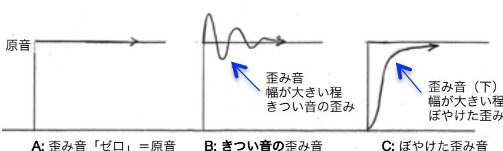
図1 歪み音概念図（右方向は時間軸、垂直方向は音量）
