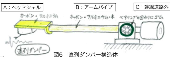
実は、この直列ダンパー構造体は、カートリッジでも使われています。カートケースをABSやアルミニウムなどのやわらかな材料で接続されると、その音は材料レベルの音になるでしょう。
