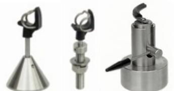
支点の下の出力コード取付部は極めてシンプルな構造としました。ネジはM8で、芯の部分にリード線が通る場所、この部分をプレーヤーに合わせてベース部を作れば、付属のベースを使用せず、さらに各種プレーヤーに取付可能です。
