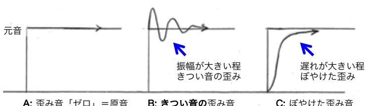
図1 歪み音概念図（右方向は時間軸、垂直方向は音量）
